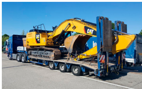
Schwere Bagger bis 36t sicher verladen und transportiert.
