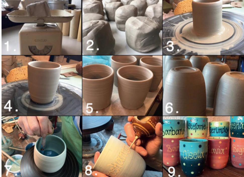
Der Weg zum Ton-Produkt: → 1. wägen → 2. kneten → 3.+4. drehen → 5.+6. abdrehen → 7.+8. bemalen, Vorbrand, glasieren, Glattbrand → 9. fertig
