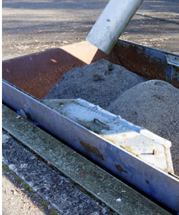
Der im Sandfang ausgeschiedene Sand ist nicht für den Bau geeignet, kann aber als Inertstoff deponiert werden.
