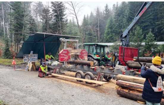
Die mobile Säge schneidet Stämme vor Ort zu Balken oder Brettern.
